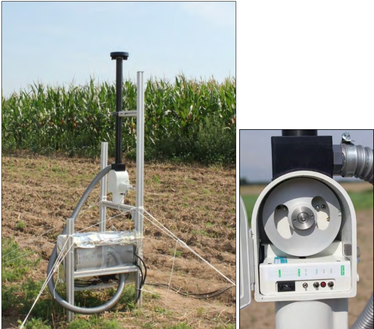
Abb. 25: Pollenmonitor PMO von TIEM-technic GbR (hier am Standort AN2 in 190 m Abstand vom Maisfeldrand): High-Volume-Aktivgerät (1.000 l/min) mit Rundum-Einlass und elektronisch geregelter Impaktionseinheit (Sporewatch, Burkard Scientific Ltd). Das Gerät ist zur Erfassung von Maispollen auch im Nahbereich von Quellen geeignet. Abscheidung über Impaktor (14 mm x 2 mm) auf Trommel mit Klebefilm. Der entnommene Teilvolumenstrom beträgt 10 l/min, die Umdrehungszeit der Trommel ist einstellbar von 1 Minute bis 7 Tage (Einstellung 7 Tage, 2 mm/h). Die Falle benötigt 230 V-Anschluss, Leistung ca. 300 W. Einlasshöhe einstellbar: Außerhalb der Felder in 1,8 m Höhe wie Passivsammler Sigma-2/PMF (links, AN2), innerhalb des Maisfeldes erfolgte eine Nachführung in Höhe der Quelle der Pollenemission (Fahnen-/Bestandshöhe). (Bilder: Hofmann)
