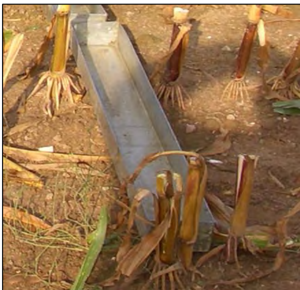
Abb. 154: Metallwannen-Streufalle 1 m x 0,1 m x 0,1 m (VERN e.V.). (Bild: Hofmann)
