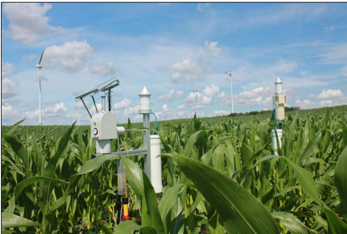
Abb. 73: Pollenmonitor PMO-LV Solar mit Passivsammler PMF (AN5) und PMF/Sigma-2 (AN6) am Standort AN5 im Maisfeld B kurz vor Blühbeginn am 19.7.2011. (Bild: Hofmann)
