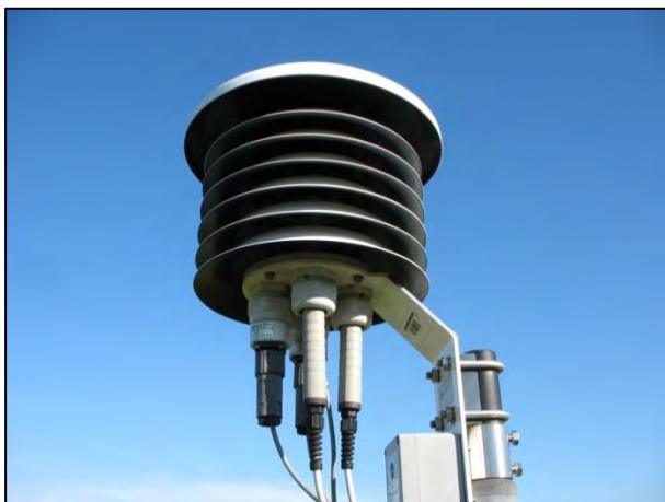
Abb. 44: Temperatur- und Feuchtesensor mit Strahlungsschutz. (Grafik: Wittich)
