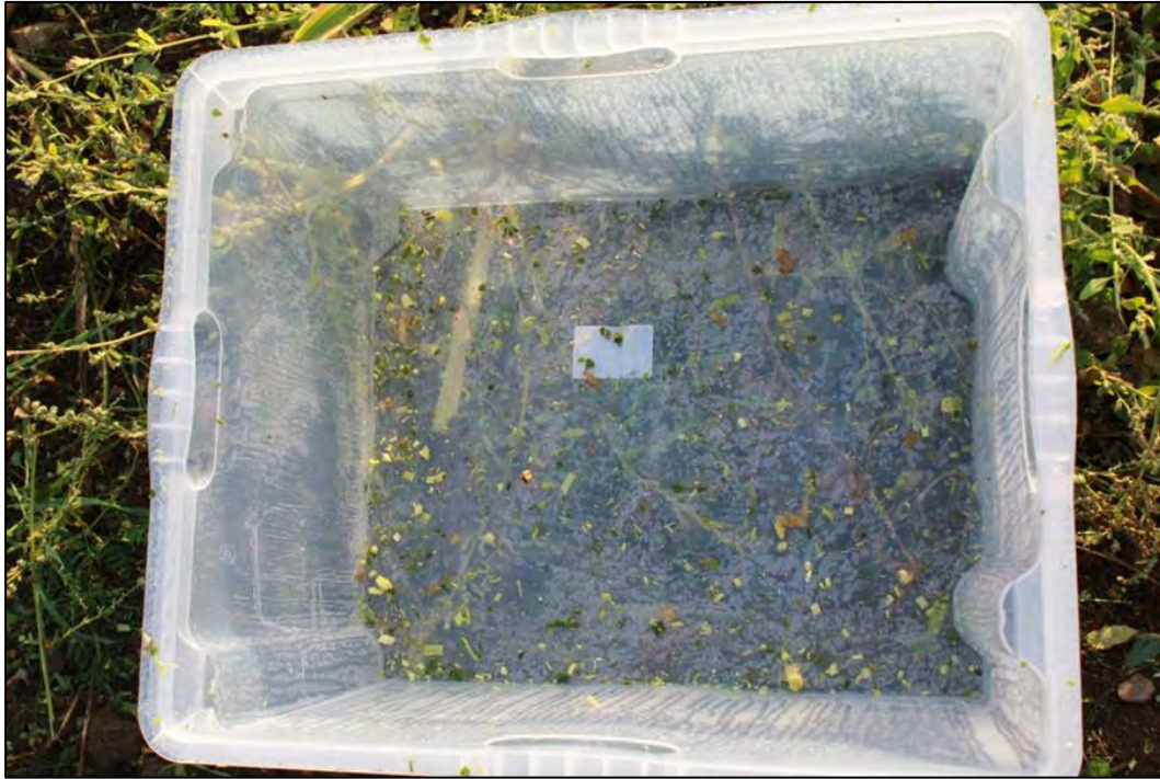
Abb. 168: Streufalle nach Durchgang der Erntemaschine. Gut zu erkennen sind die größeren Bestandteile des eingetragenen Maisstreuerguts. (Bild: Hofmann)
