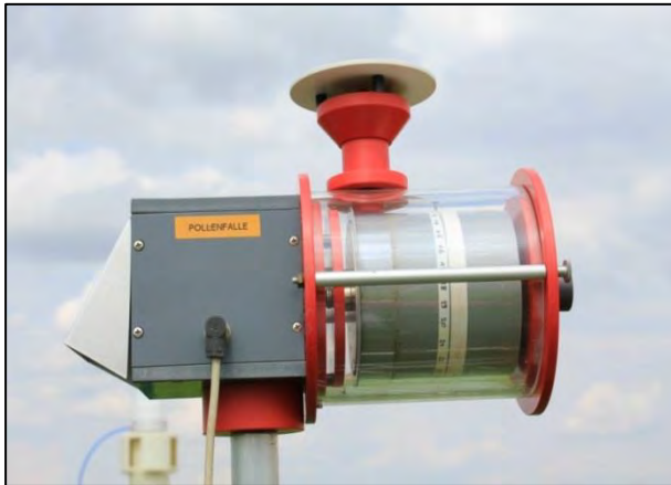
Abb. 26: Pollenmonitor des DWD. Aktivgerät mit Rundum-Einlass und Impaktion auf Trommel mit Klebefilm, ebenfalls für die Erfassung von Maispollen auch im Nahbereich ausgelegt. Der von einem Lüfter erzeugte Volumenstrom beträgt 10 l/min (Low-Volume) analog zur Hirst-Falle (Burkard, Lanzoni), die Umdrehungszeit der Trommel 7 Tage (2 mm/h), die Schlitzweite des Impaktors 4 x 16 mm. Stromanschluss: 230 V. Die handliche Falle kann vom Verbrauch her auch über 12 V-Batterie bzw. über Solarpanel mit Akku betrieben werden. (Bild: Hofmann)
