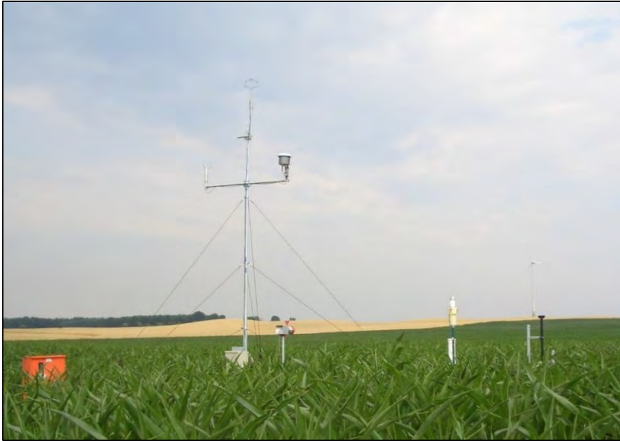
Abb. 39: Messplatz AN6 inmitten des Maisfeldes zum Zeitpunkt der Installation vor der Maisblüte Mitte Juli. Messstation mit 3D-Ultraschall-Anemometer (USA) an der Spitze (6,85 m), 2-D USA, Feuchte- und Temperaturmesseinheit, Datenlogger. (Grafik: Wittich)
