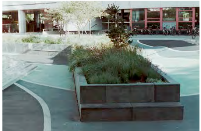
Der Wasserplatz Benthemplein in Rotterdam wirkt wie ein konventioneller Stadtplatz. Sobald es heftig regnet, entfaltet er jedoch seine volle Leistung als Kombination aus grüner und grauer Infrastruktur durch Rückhaltung und langsame Versickerung von Regenwasser (K. Lindschulte)
