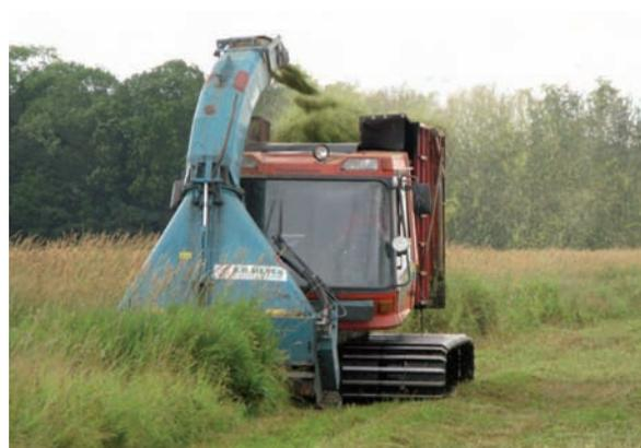
Abb. 18: Erntemaschine für Feuchtgrünland, basierend auf einem Pisten-Bully
