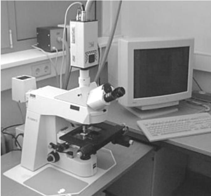
*Abb. 2.2.6: Bildanalyseeinheit beim DWD mit Präzisionsmikroskop (Zeiss),
