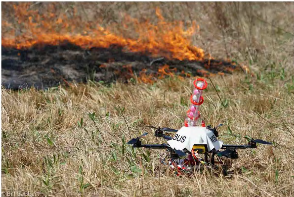
Abb. 5: Drohne zur unbemannten Zündung auf dem Pyroshot-Prinzip (B. Gabbert University of Nebraska-Lincoln)
