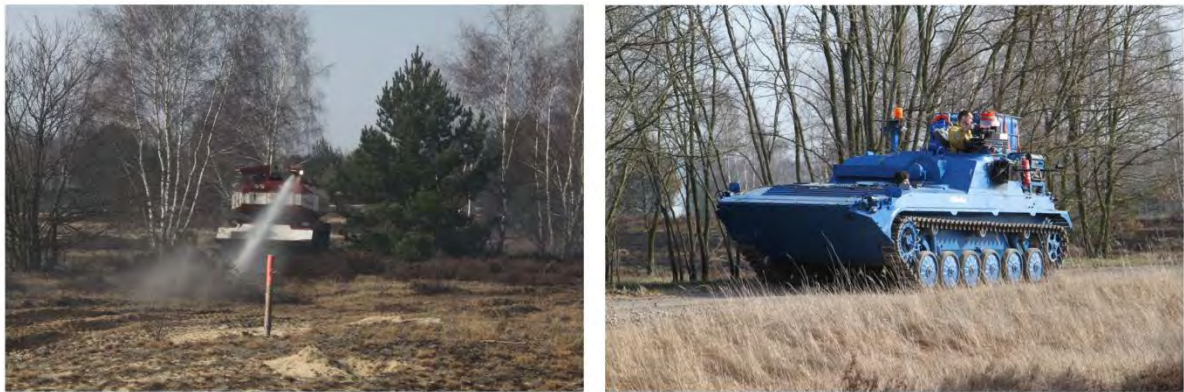
Abb. 2: Die gepanzerten Kettenfahrzeuge als Kernbestandteile des Erprobungsprojektes; links Löschpanzer „SPOT 55“, rechts Kettenfahrzeug „BMP-OT-R5“ (E. Brunn)
