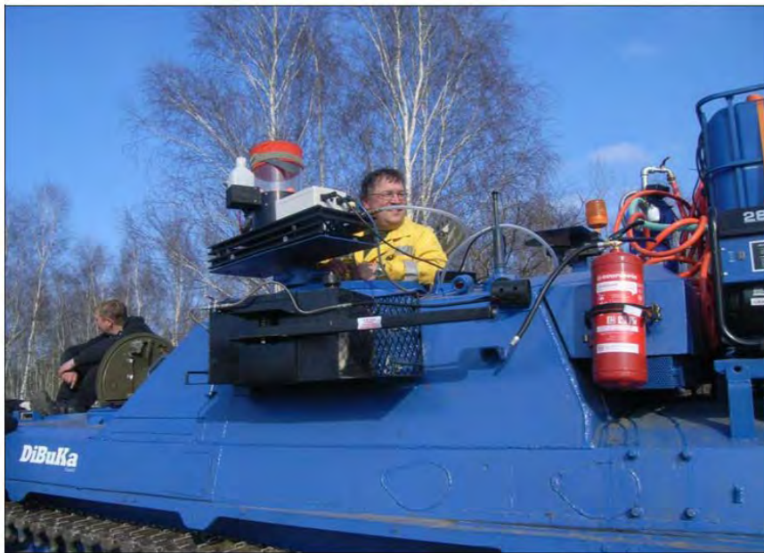
Abb. 3: Die am Kettenfahrzeug „BMP-OT-R5“ montierten Zündkomponenten; oben das Pyroshot-Gerät „green dragon“, darunter die ATV-Driptorch (GFMC)
