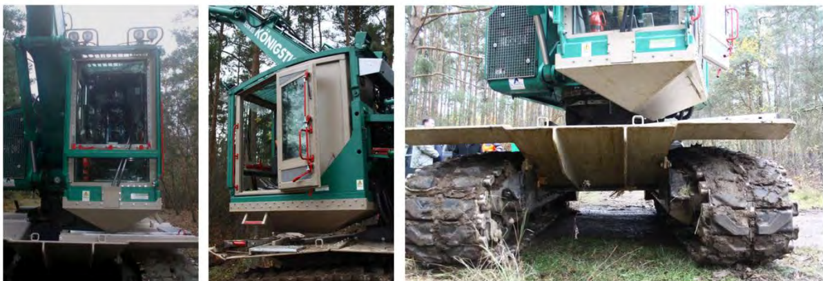
Abb. 9: Schutzkomponenten des Raupenharvesters „Königstiger“ beim Einsatz auf der bundeseigenen Naturerbestfläche Kleintrebnitz bei Zeithain (E. Brunn)
