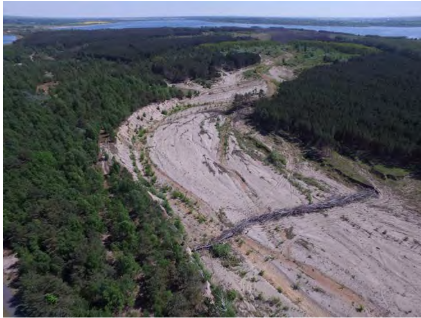
Abb. 4: Setzungsfließ- und rutschungsgefährdeter Sperrbereich im Ostteil der im Bitterfelder Braunkohlerevier gelegenen Naturerbe-Fläche „Goitzsche“ (Sachsen-Anhalt) (André Schmiedel).
