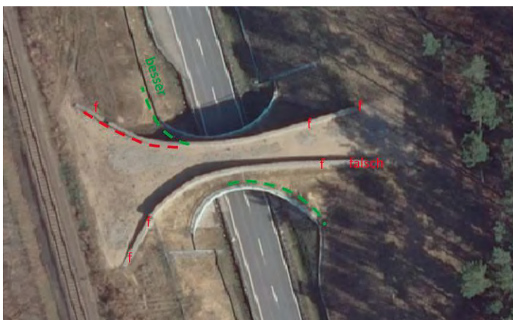
Abb. 37: Überlängen von Schutzwänden
