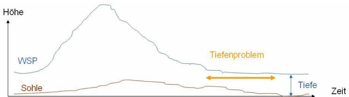
Abb. 17: Prinzipskizze –Veränderung der Sohle während Hochwasser.
