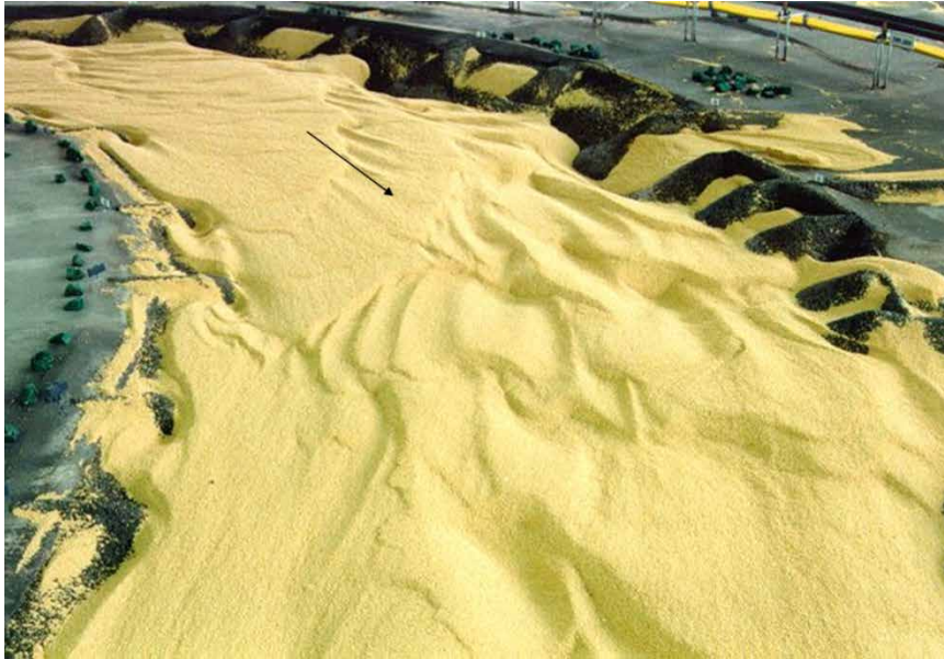
Abb. 16: Sohle in einem Maßstabsmodell der Elbe bei Elbe-km 510.
