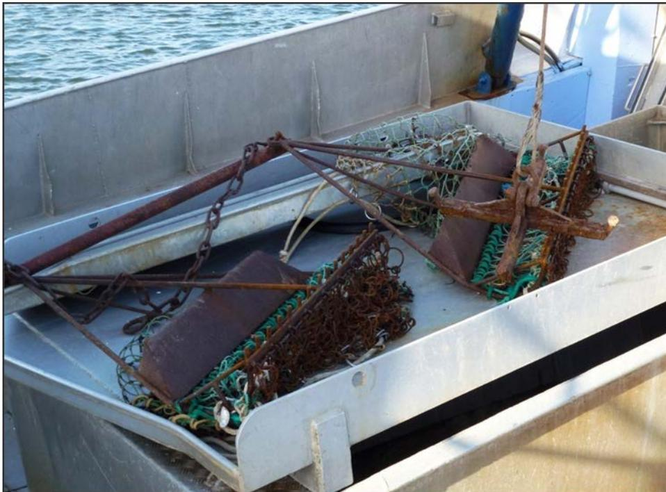
Abbildung 37: Für die Austernfischerei ist die Verwendung kleiner und leichter Dredgen (max. 35 kg) vorgeschrieben.
