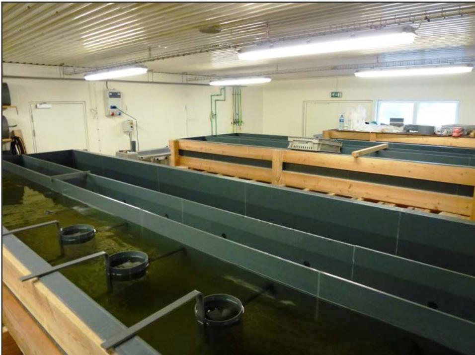
Abbildung 25: Halle zur Anzucht von Saataustern (engl.: spat). In den runden Behältern, die in den rinnenförmigen Tank eintauchen befinden sich frühe Stadien von Saataustern.
