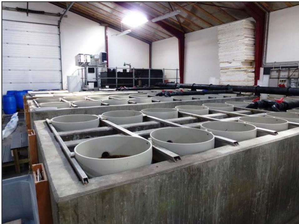
Abbildung 33: Die Betontröge enthalten mit Mikroalgen angereichertes Produktionswasser. Darin hängen die siebartigen Rundbehälter mit den Saataustern.
