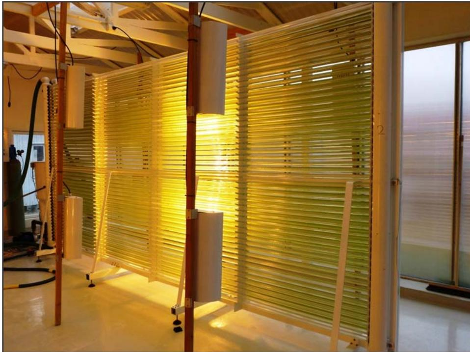
Abbildung. 22: Massenproduktion von Mikroalgen in einem Photobioreaktor-System (Biofence).
