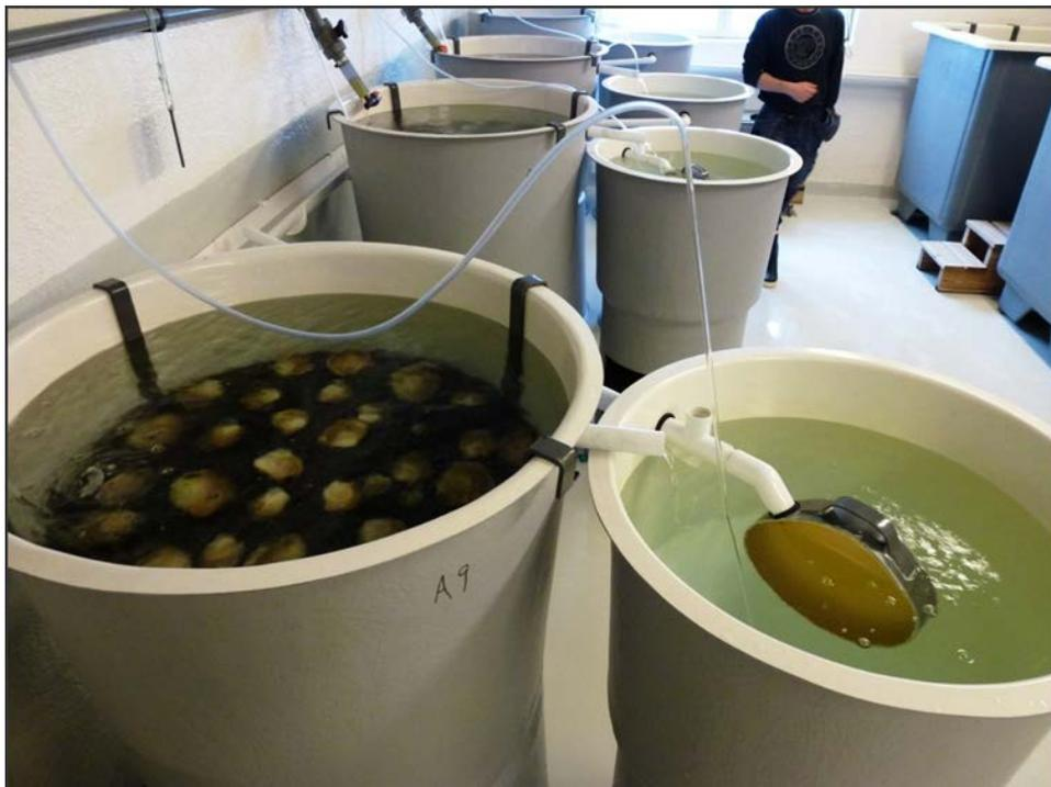
Abbildung 23: Brutansatz mit einer Gruppe von Austern. Die positiv phototaktischen Larven gelangen durch den Überlauf in ein Auffangbecken.
