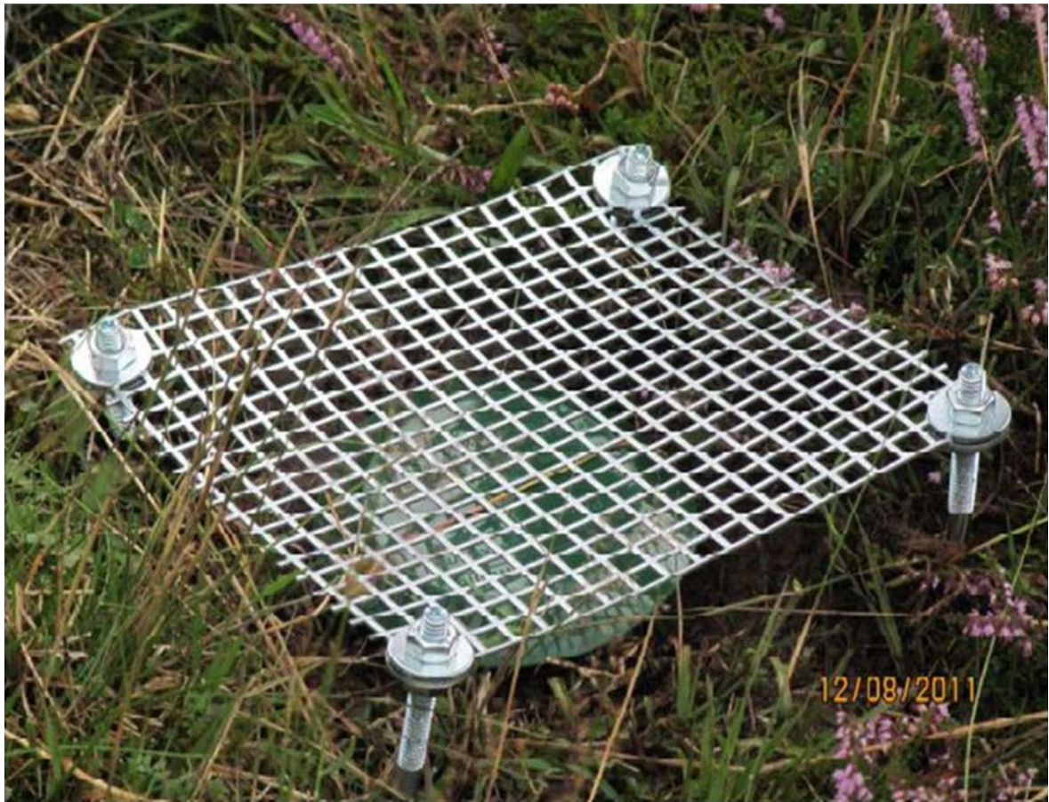
Abb. 3: In Waldstandorten ist zum Schutz vor Laubeintrag ein Gitter oberhalb der Fallen anzubringen (Foto: F. Borchard).
